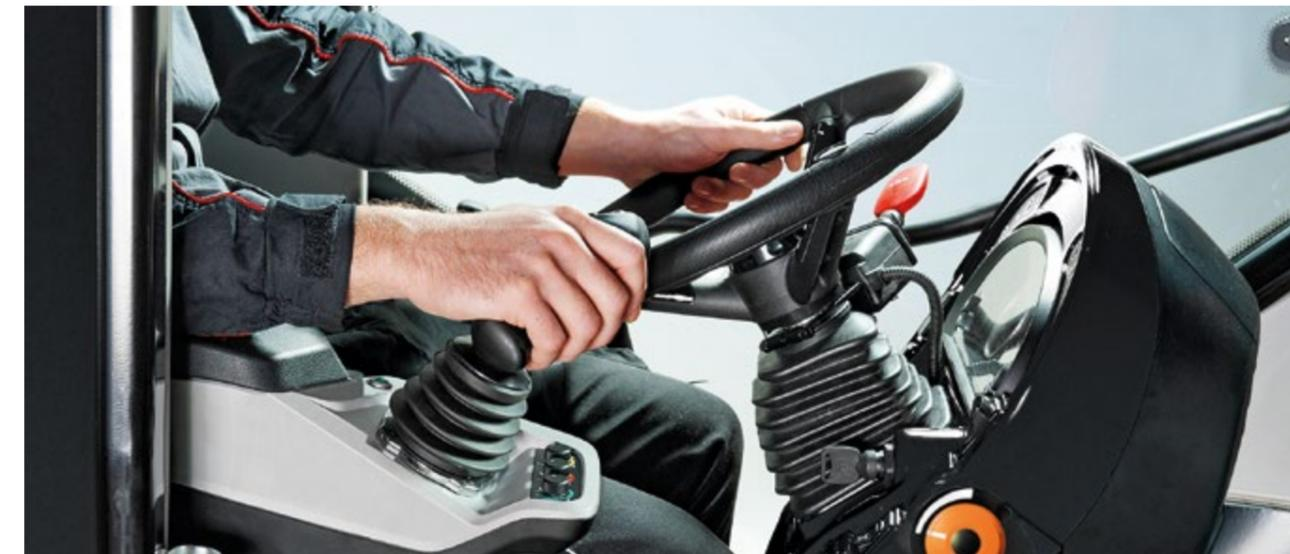
Le joystick proportionnel JMC™ (en option) représente une grande innovation en matière d'ergonomie et de flexibilité et permet d'actionner le relevage et les prises hydrauliques avant et arrière avec une extrême facilité. Il permet également de régler le débit d'huile vers les prises hydrauliques et le relevage de façon proportionnelle, pour un contrôle absolu sur la vitesse et les mouvements des outils et du relevage lorsqu'il monte et descend. Le travail se fait ultra précis.
