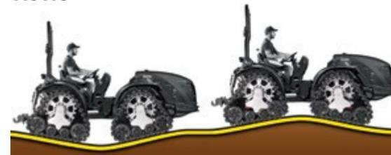
Grâce aux réducteurs AV et AR à 45°, Mach 4 conjugue un empattement long à un encombrement réduit du moteur en porte-à-faux : ces caractéristiques garantissent une stabilité parfaite pour chaque type d'opération et permettent de travailler en toute sécurité dans le plus grand confort. L'oscillation longitudinale de chaque chenille (+8°-11°), venant s'ajouter à l'oscillation du châssis ACTIO™, contribue à maintenir l'adhérence sur les terrains les plus irréguliers.
